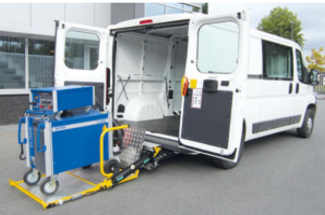
La sponda DH-C001 viene riposta in una cassetta sigillata sotto al piano di carico del veicolo. Questa soluzione offre **un accesso libero attraverso le porte posteriori del veicolo, e non occupa spazio all'interno del veicolo.**
